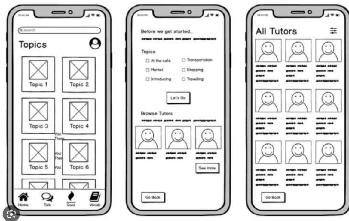
Figura 28: Representação visual de um Wireframe. Fonte: https://mindconsulting.com.br/2021/11/o-que-exatamente-e-wireframe-um-guia-completo-para-2022/
