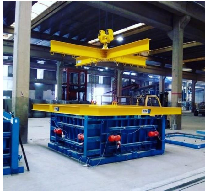
Figura 2.14 – Conjunto de formas metálicas e vibradores empregados na fabricação de aduelas de concreto (Fonte: http://www.tgm.ind.br/produtos/pluvial-e-saneamento/forma-metalica-para-galeria-e-aduelas/ ).
