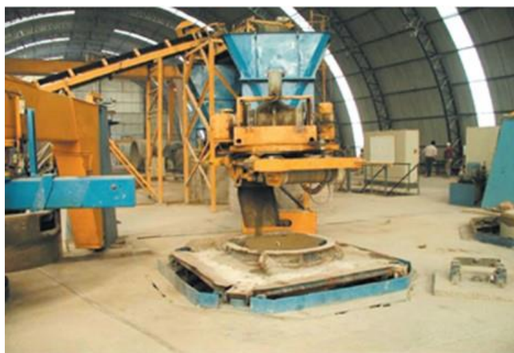
Figura 2.9 – Fabricação de tubo por processo de vibrocompressão (Fonte: Manual Técnico de Drenagem e Esgoto Sanitário – ABTC, 2008).
