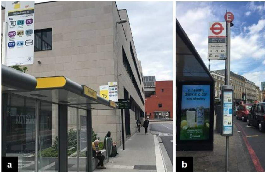
Fig. 5: a) Abrigo de ônibus preto com placas de identificação amarelas e painel digital das linhas que passam e previsão de chegada em minutos; b) Totem informativo em ponto de ônibus de Londres, Inglaterra. O símbolo identifica o sistema e logo abaixo há a informação da localização da parada, informação da direção geral que as linhas que param ali seguem, número das linhas, e com fundo azul, o número das linhas noturnas, respectivamente. Mais abaixo, no centro do poste do totem estão as informações de frequência / horários de cada linha.
