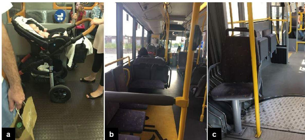
Fig. 14: Layout interno dos veículos e espaços livres para pessoas sobre rodas. (a) área preferencial para pessoas sobre rodas; (b) marcação em amarelo no piso do ônibus com o símbolo internacional de acesso; (c) assento individual e assentos rebatidos.
