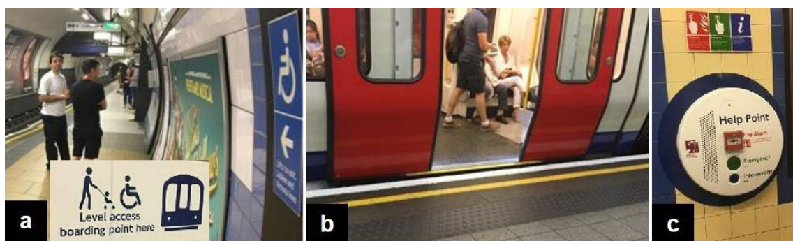
Fig. 10: Imagens de a) estação antiga de metrô em Londres onde pode ser observar o b) nivelamento entre a plataforma e o vagão c) presença de Help Point. Fonte: SILVEIRA, 2017, p. 213 - 223.
